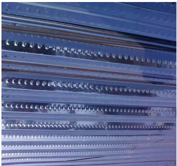
热镀锌钢楼承板顶面(一)
