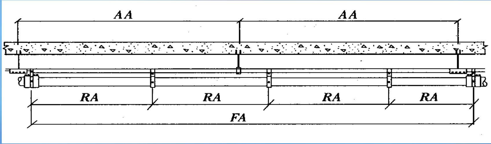
图1 DN40~DN200的HDPE管横管固定装置
