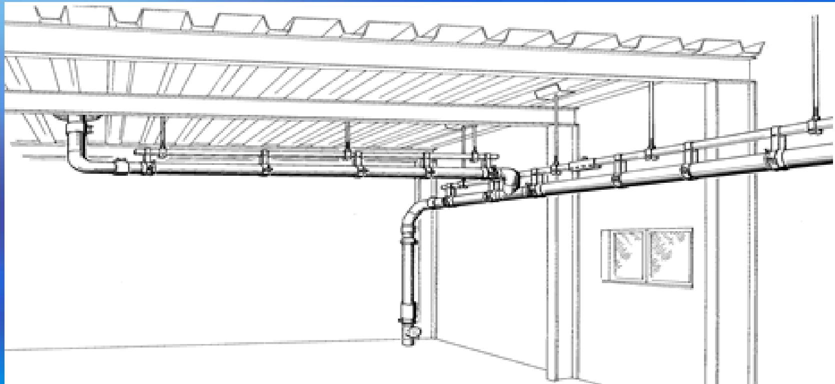
由于系统形成虹吸时管道中水流速较大会发生振动，同时造成噪音，塑料管道还会发生热胀冷缩现象，从而产生温度应力，容易对固定点产生破坏，因此系统的固定是非常重要的。
