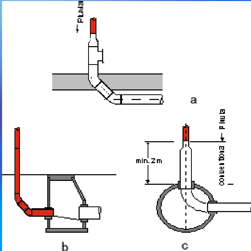
(a) 图表示在连接前先在垂直管上扩大管径；
