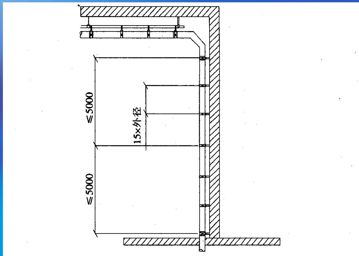
图3 HDPE管垂直固定装置
